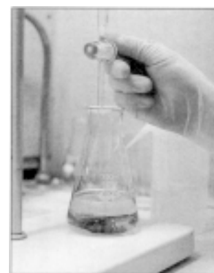
Figura 19. Medindo a acidez espontânea em laboratório.
