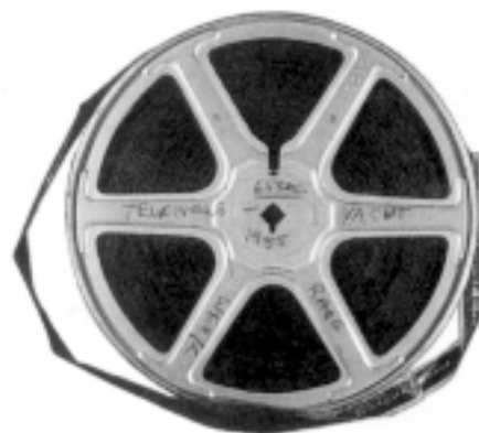
Figura 13. Filme cinematográfico de 16mm, que bradiço e contraído.
