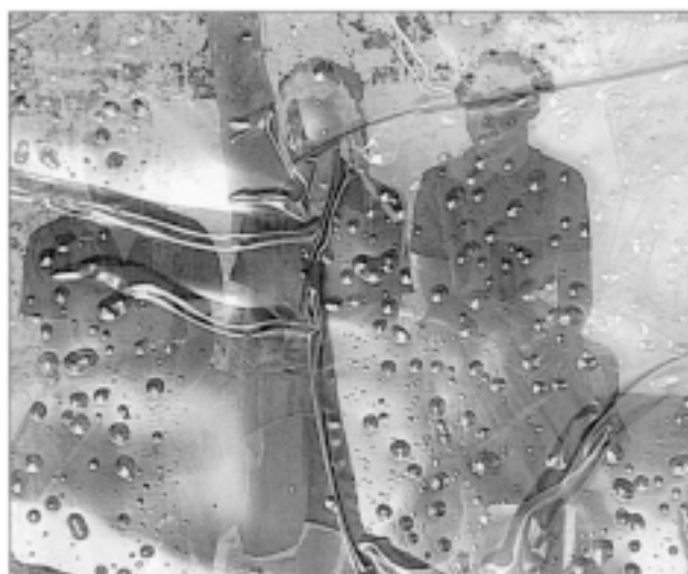
Figura 14. Chapa de filme de acetato deteriorado mostrando estriamento e protuberâncias circulares de plastificante cristalizado sobre a emulsão da gelatina.
