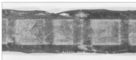
Figura 12. Microfilme de acetato de 35mm quebradiço e contraído.
