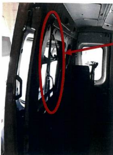
Imagem do conjunto de cinto de segurança a ser retirado
