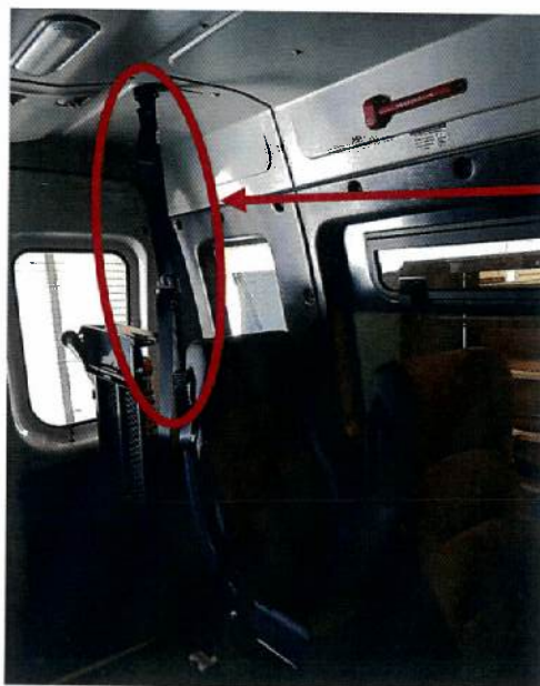
Imagem do conjunto de cinto de segurança a ser reposicionado
