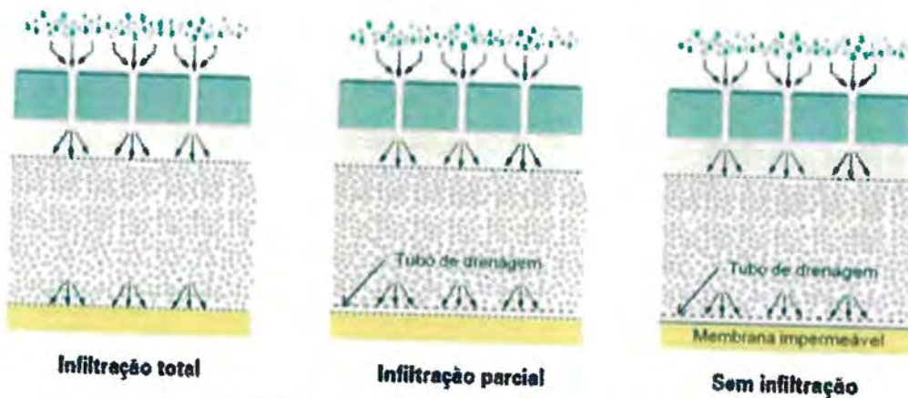
Figura 1 – Tipos de sistema de infiltração
