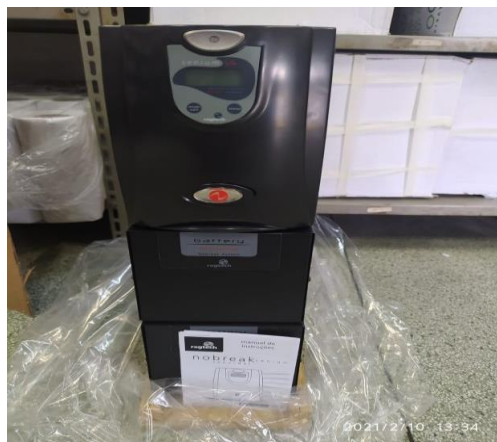
Nobreak para estabilização de equipamentos, a ser utilizado na Seção Microbiológica
