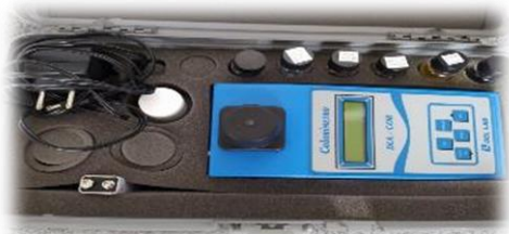
Turbidímetro de bancada - 01 unidade
