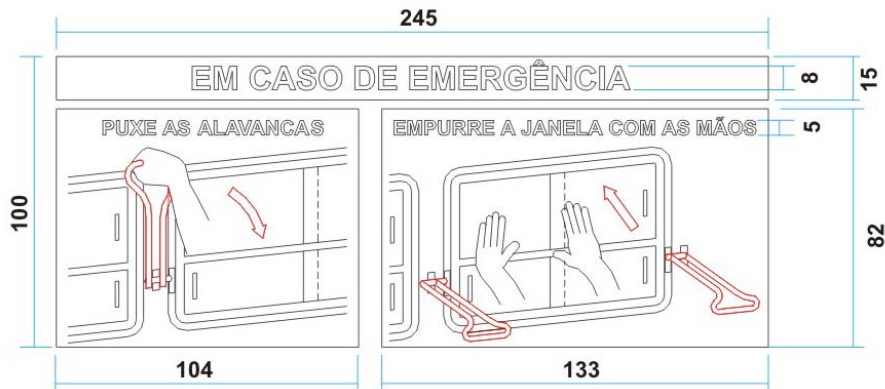
Figura 9 — Modelo de adesivo de indicação do acionamento da janela de emergência
