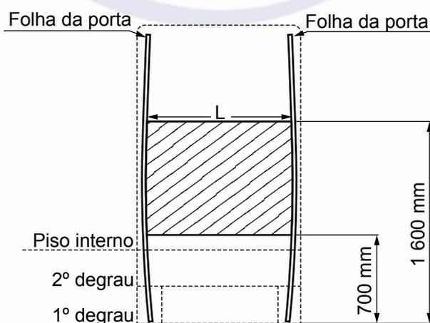
**Figura 10 – Obtenção da largura nas portas**
