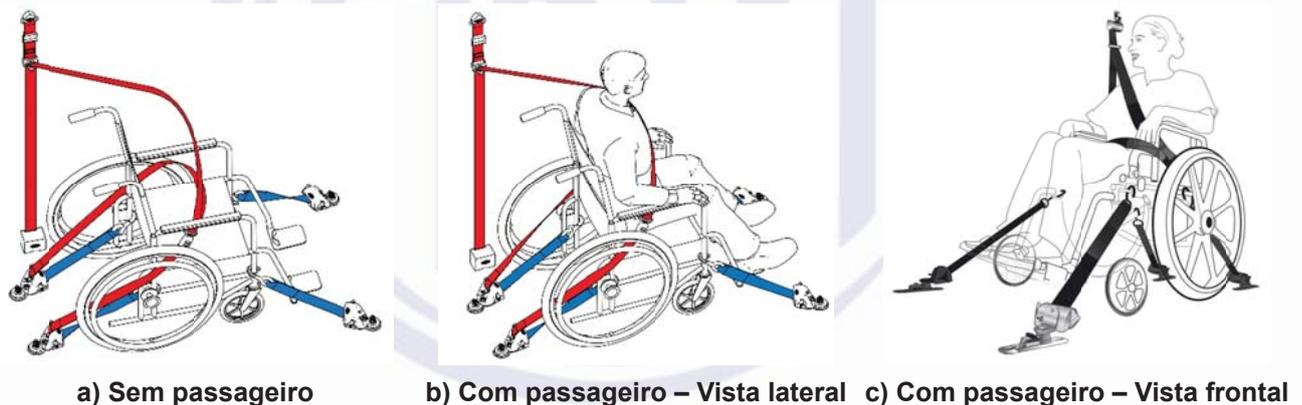
**Figura 39 – Exemplo do sistema de travamento fixado no piso**
