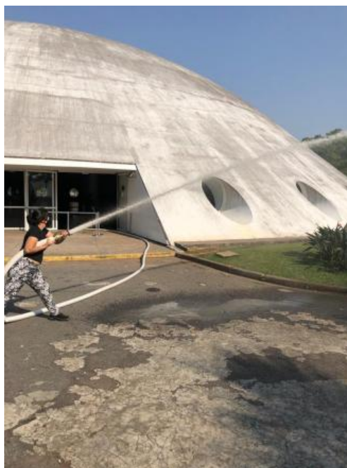
Imagem 11: Teste de medição do jato de hidrante.
