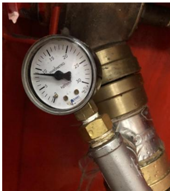
Imagem 30: Teste com tubo de pitot direto na válvula globo angular.
