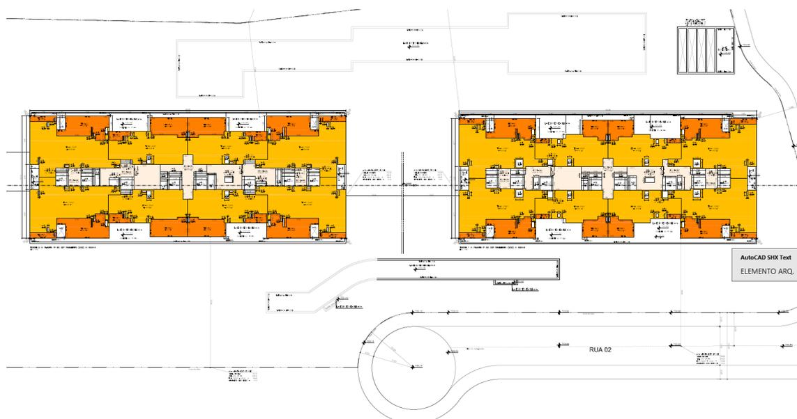
Figura 16 - Planta do pavimento tipo – 1º ao 32º pavimento das torres 1 e 2 do setor B1.
