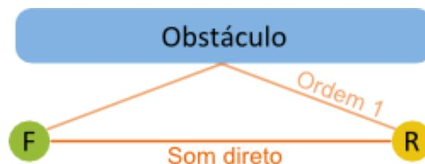
Figura 6 - Propagação do som entre uma fonte F e um receptor R, com reflexões de primeira ordem.
