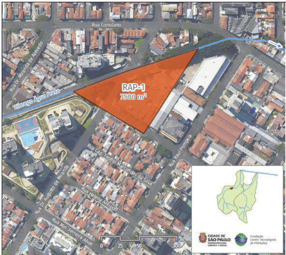
Figura 5.2 - Indicação da posição do reservatório RAP-1 na área da Praça Ilza Weltman Hutzler e do pátio de estacionamento particular (Fonte: FCTH, 2019).
