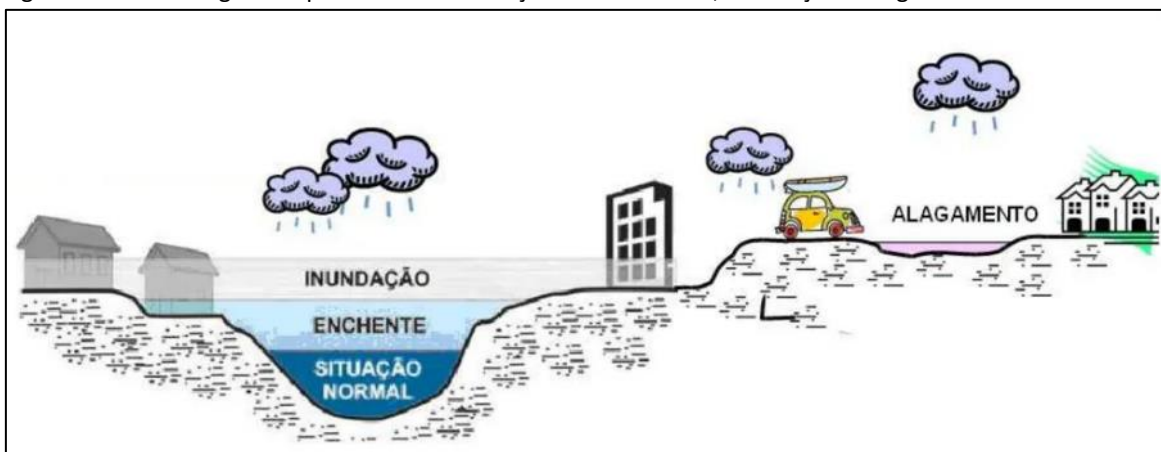
Figura 54 – Modelo gráfico que ilustra a diferença entre enchente, inundação e alagamento.
