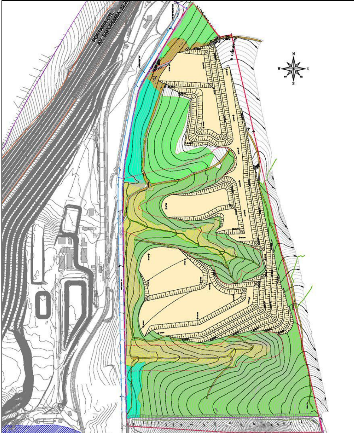
Figura 7 – Configuração da escavação inicial da Área de Movimento de Solos Isolada
