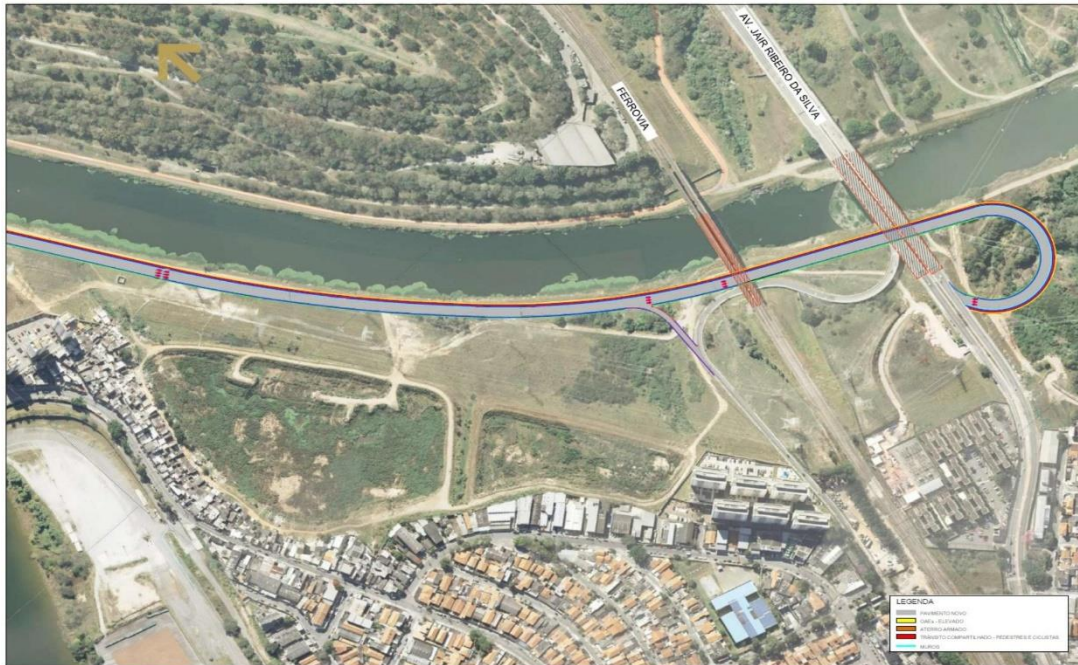
Figura 6-6 - Prolongamento da via, com acesso em cinza (pavimentação nova). A linha em vermelho locais de compartilhamento com pedestres e ciclistas
