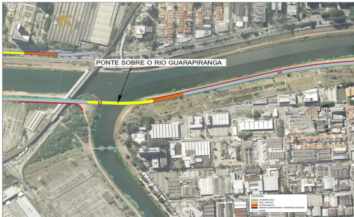
Figura 6-2 - Ponte projetada sobre o Rio Guarapiranga. Em amarelo, indicam setores elevados, em cinza setores novos, em laranja setor de aterro armado e em vermelho locais de compartilhamento com pedestres e ciclistas
