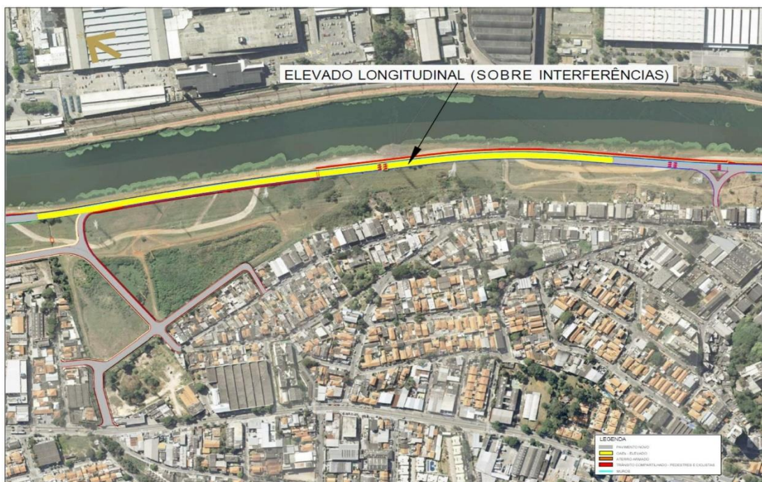
Figura 6-5 - Setor elevado projetado. em cinza setores de pavimentação nova e em vermelho locais de compartilhamento com pedestres e ciclistas
