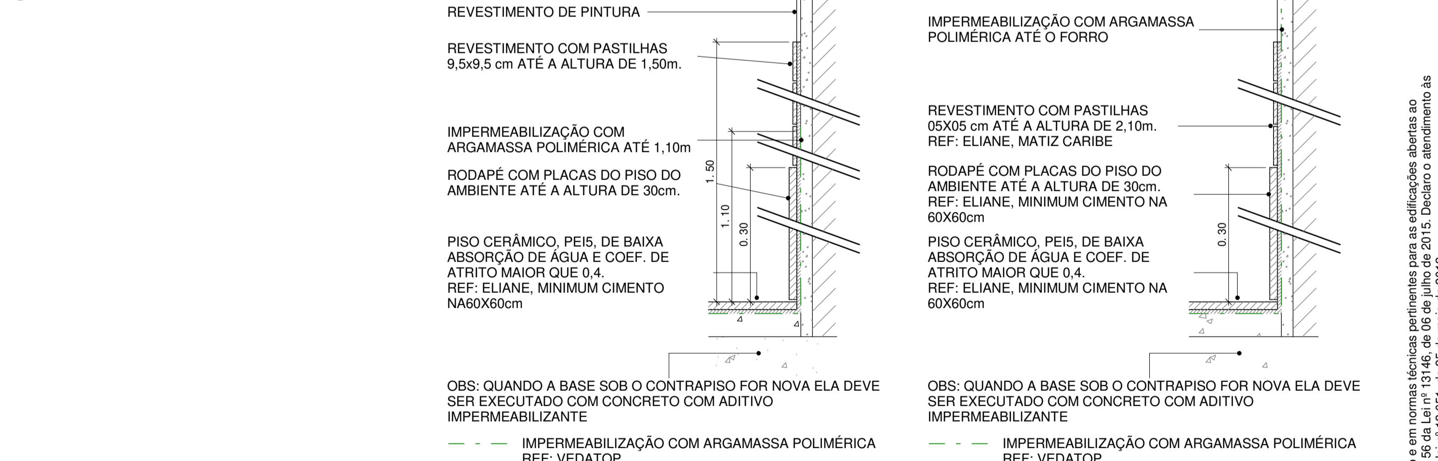
6 DET. Parede de áreas molhadas 1 : 5
