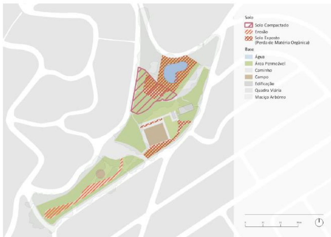
Figura 12. Mapa com a área de solo exposto, compactado e erosão. Fonte: (Plano Diretor 2019).
