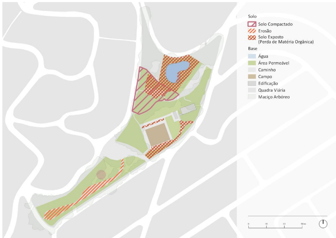
Figura 7. Áreas de solo exposto, compactado e erosão. Fonte: PMSP
