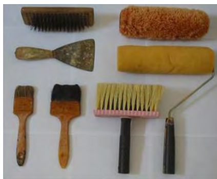
Fotos 39, 40 e 41 – Materiais e ferramentas para a elaboração da tinta de terra.
