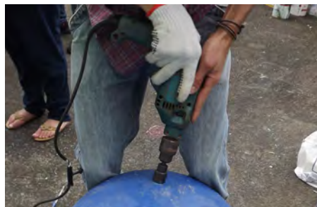
Foto 33 – Furo de 20mm para encaixe da flange.
