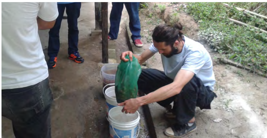
Foto 2 – Lavagem da argila expandida com tela de mosquito.
