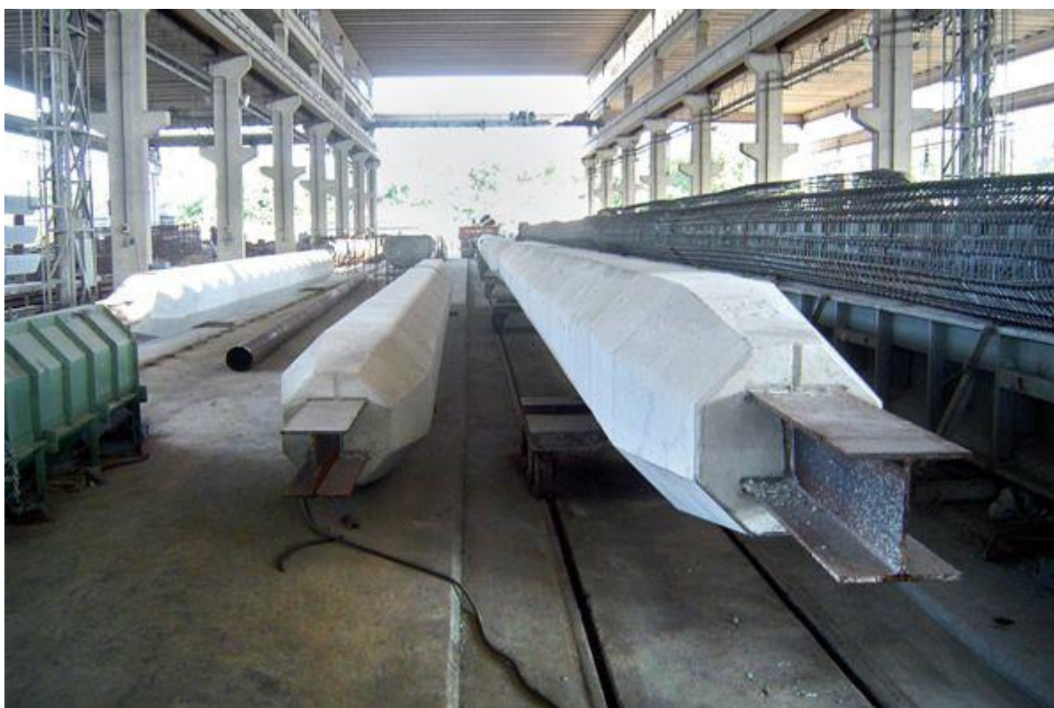
Norma publicada em fevereiro deste ano disciplinou os critérios da fabricação, manuseio e estocagem das estacas pré-fabricadas de concreto
