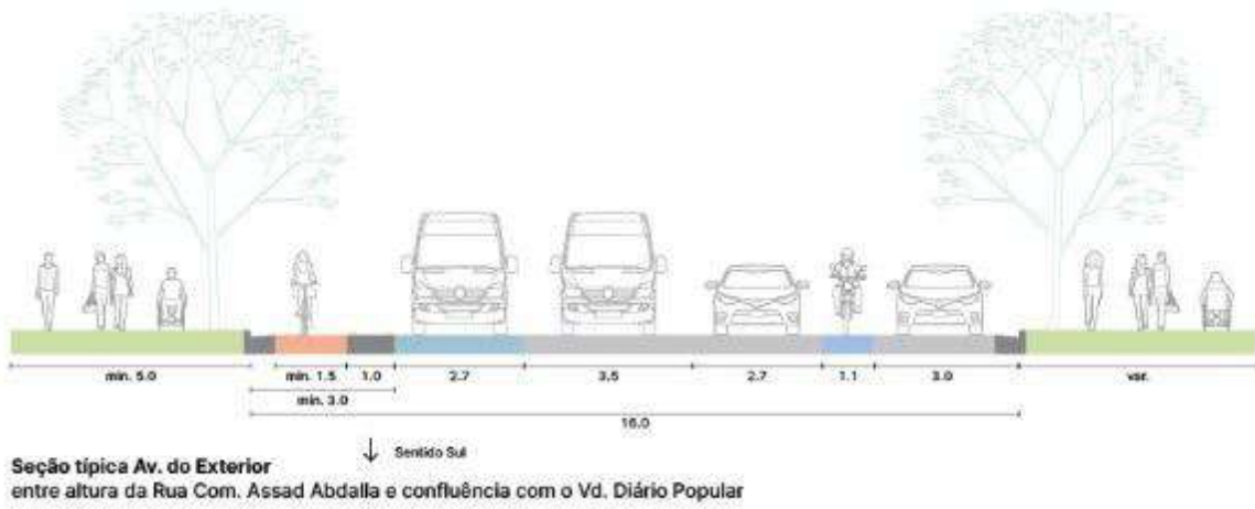
Figura 30 - Seção da Avenida do Exterior – Trecho 1.
