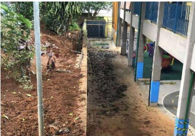
FOTO 9 PÁTIO EXTERNO, MURO DE ARRIMO EM DESAPRUMO.
