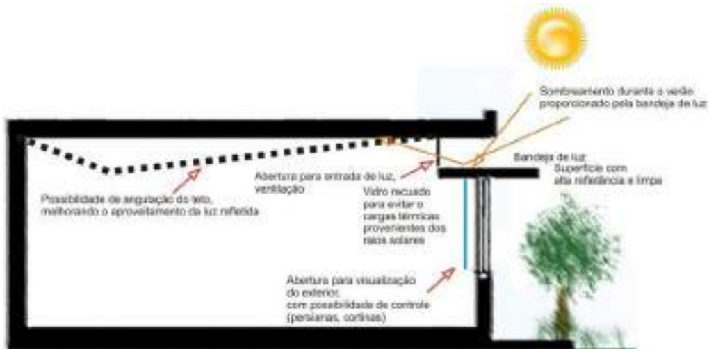
Figura 64. Referencial: “Corte esquemático de uma sala de aula padrão da FDE, com a incorporação de estratégias integradas para controle solar”.
