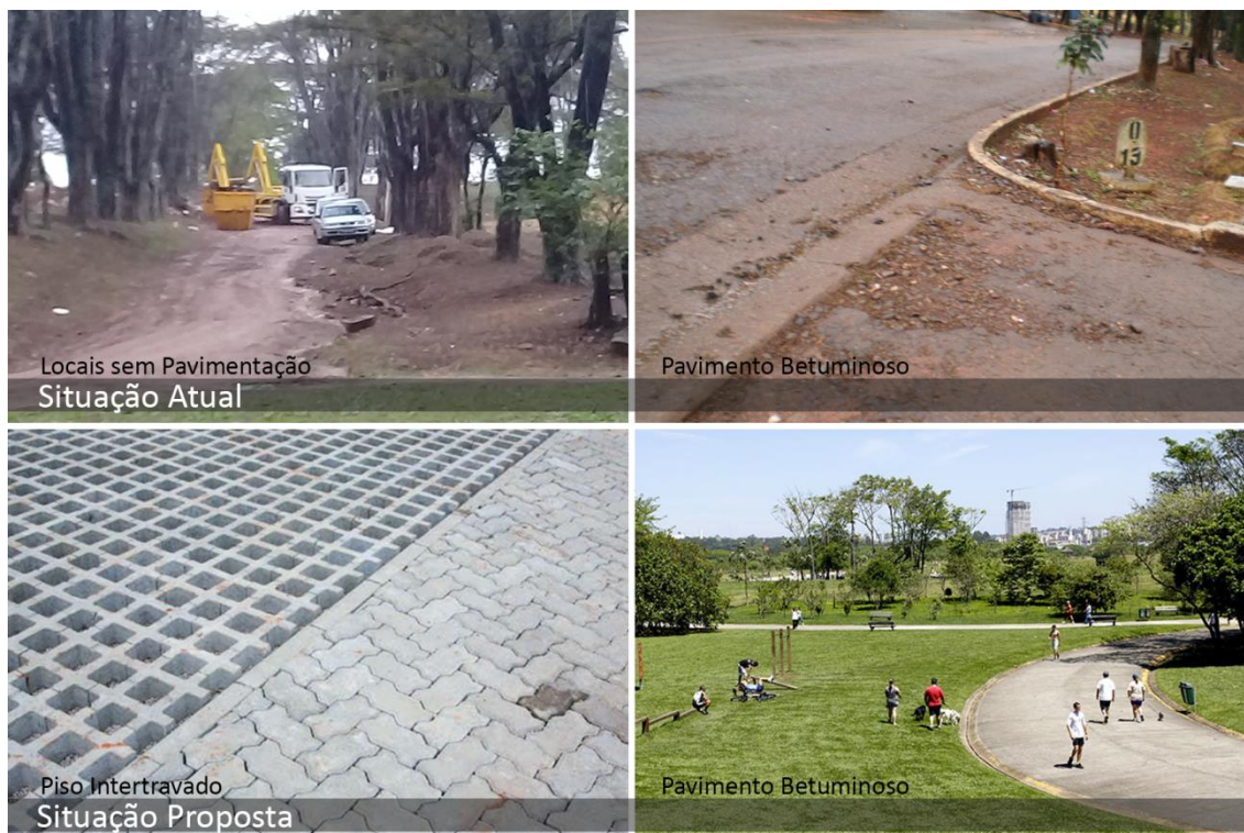
Figura 29 - Infraestrutura de Pavimentação Atual e Proposta
