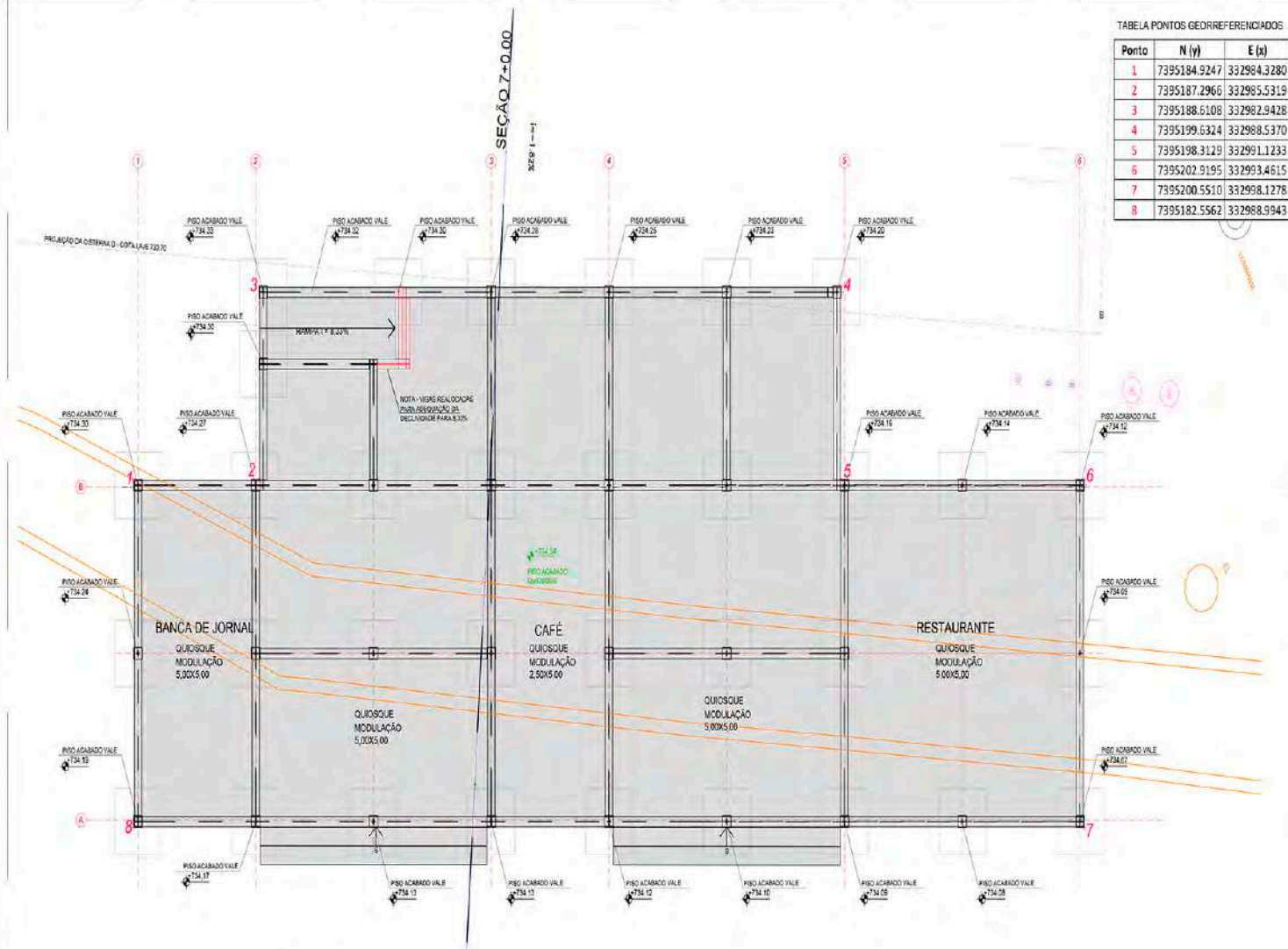
QUIOSQUE 08 - IMPLANTAÇÃO + FUNDAÇÃO ESC. 1:50
