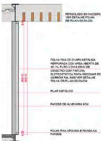
C08A CORTE A ESC: 1/25 *MEDIDAS EM CM
