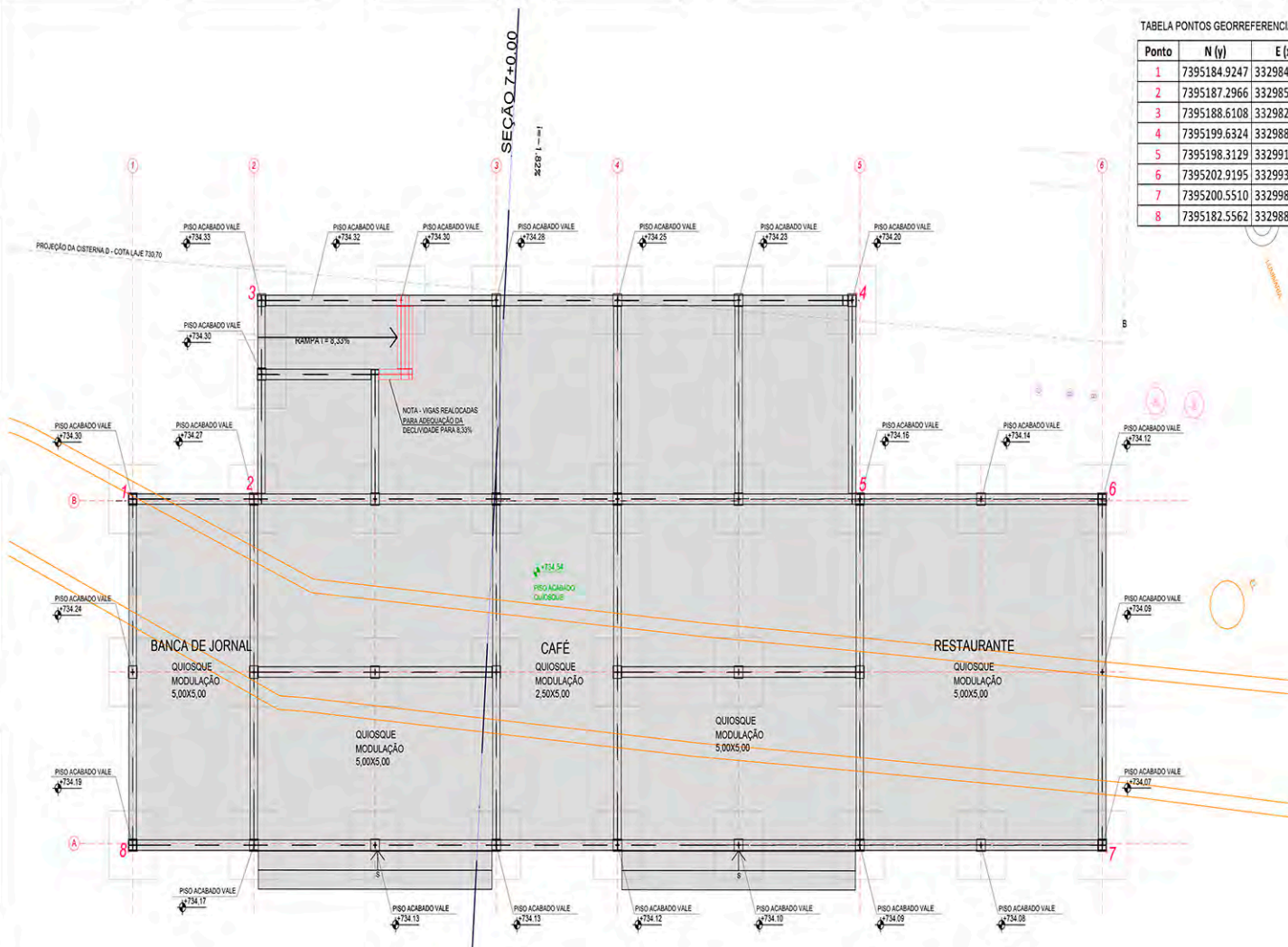
QUIOSQUE 08 - IMPLANTAÇÃO + FUNDAÇÃO ESC. 1:50
