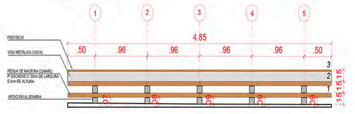
DETALHE 03B ESCADA 2 - ELEVÇÃO 01 ESC. 1:25
