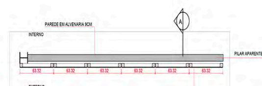
C09A PLANTA ESC: 1/25 LOCALIZAÇÃO: QUIOSQUES 7 E 9 QUANTIDADE: 12 *MEDIDAS EM CM **PARA A EXECUÇÃO DOS CAIXILHOS, CONSULTAR ESPECIALISTA
