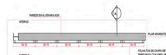
C09B PLANTA ESC: 1/25 LOCALIZAÇÃO: QUIOSQUE 1 QUANTIDADE: 06 *MEDIDAS EM CM **PARA A EXECUÇÃO DOS CAIXILHOS, CONSULTAR ESPECIALISTA
