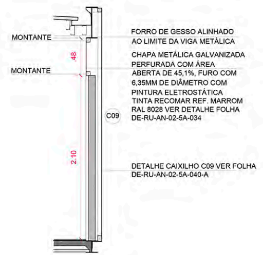
DET.2 CHAPA METÁLICA ESC: 1:25
