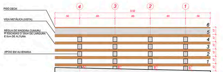
DETALHE 03B ESCADA - ELEVACAO 01 ESC: 1:25
