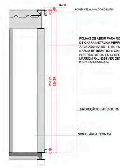
C17 CORTE A ESC: 1/25 *MEDIDAS EM CM
