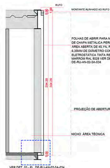
C16 CORTE A ESC: 1/25 *MEDIDAS EM CM
