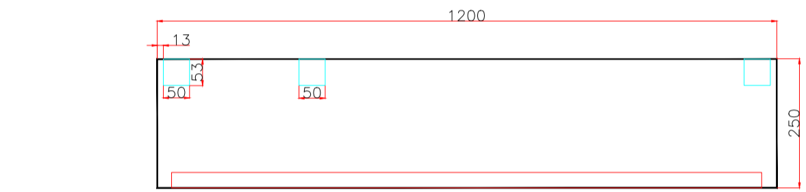
VISTA SUPERIOR RECORTE DAS CANALETAS
