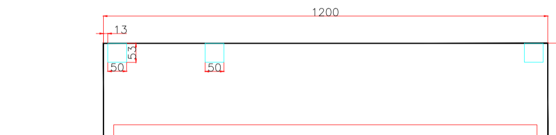
VISTA SUPERIOR RECORTE DAS CANALETAS
