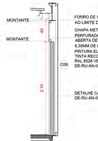
DET.2 CHAPA METÁLICA ESC: 1:25
