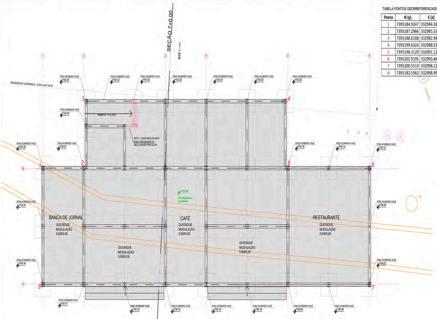
QUIOSQUE 08 - IMPLANTAÇÃO + FUNDAÇÃO ESC. 1:50
