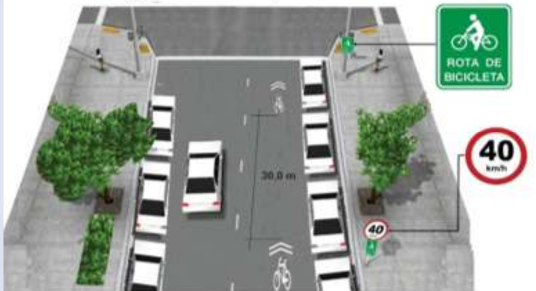
Figura 2: Modelo padrão de ciclorrota
