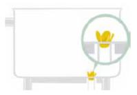
Utilize um pano úmido e a água armazenada para lavar as paredes e o fundo da caixa. Se a caixa for de fibrocimento, substitua o pano úmido por uma escova de fibra vegetal ou de fio de plástico macio. Não use escova de aço, vassoura, sabão, detergente ou outros produtos químicos;
