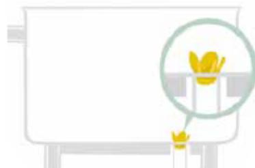
5. Utilize um pano úmido e a água armazenada para lavar as paredes e o fundo da caixa. Se a caixa for de fibrocimento, substitua o pano úmido por uma escova de fibra vegetal ou de fio de plástico macio. Não use escova de aço, vassoura, sabão, detergente ou outros produtos químicos;
