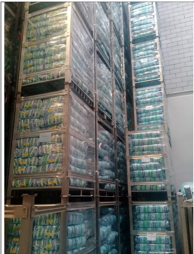
Figura 3: Exemplo de armazenagem de produto em grande volume sem restrição de empilhamento do fabricante.
