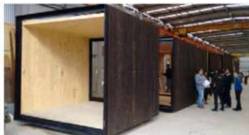
Produção industrial dos módulos prontos em CLT
