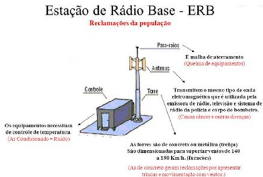
Figura 1 – Estação Rádio-Base típica
