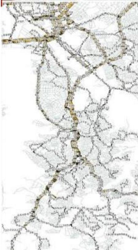
Os volumes de ônibus tem variações entre 80 e 240 ônibus/hora pico manhã com o trecho do binário extremamente carregado, a via necessita de tratamento em pavimento rígido, paradas alteadas para uma melhor fluidez do transporte público coletivo.
