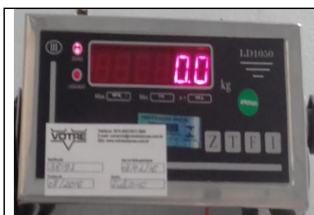
Foto 04: Balança da Sala de Roupas Limpa - Data da última calibração 08/02/16 (Data expirada)
