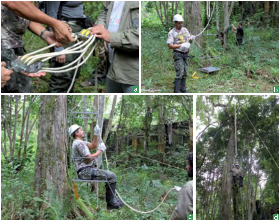
Figura 43 – Plataforma móvel para captura em copa de árvore. a) Montagem do mecanismo de roldanas; b) Instalação da corda de sustentação da plataforma e do equipamento de segurança; c) Suspensão da plataforma até a copa da árvore pelo próprio profissional; d) Suspensão da plataforma até a copa da árvore pelos auxiliares
