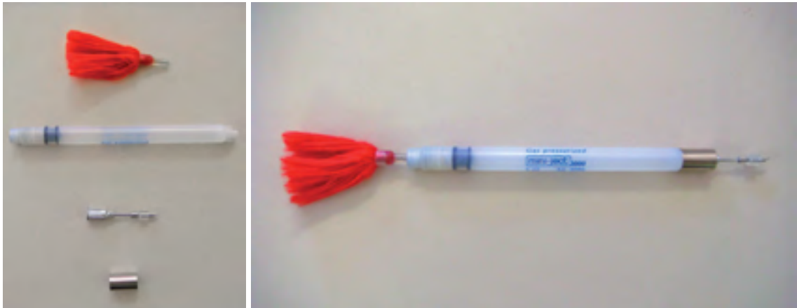
Figura 19 – Componentes do dardo e montagem
