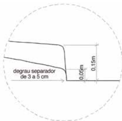
Detalhe de degrau separador no acesso de veículos
