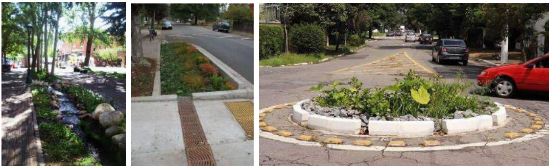
Diferentes modelos de jardins de chuva. Fonte: Gutierrez & Ramos (2019).
