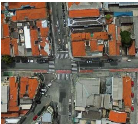
Cruzamento das ruas Coriolano e Monteiro de Melo onde o córrego Tiburtino passa sob o posto de gasolina, localizado na esquina inferior direita. Na esquina inferior esquerda há uma grande área asfaltada próxima à calçada que poderia se tornar permeável. Fonte: Google Earth
