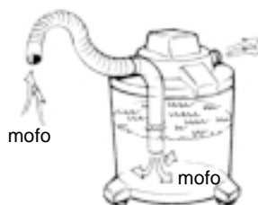
Figura 3. Alterações em um aspirador de pó, de padrão úmido-seco, irão aprisionar alguns tipos de cogumelos e alguns esporos do mofo e evitar que eles sejam espalhados para o ambiente. Um tubo conectado à base da entrada da mangueira deve ter sua outra extremidade mergulhada em um reservatório de fungicida no tanque interno do aspirador. O vapor deve ser mandado através de um tubo para fora do ambiente.
