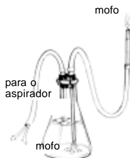
Figura 5. Um aspirador (técnico) pode ser construído a partir de um frasco de vidro, uma rolha de borracha, tubos de vidro, uma pipeta de vidro e mangueiras de plástico. Um fungicida deve ser colocado no interior do frasco para evitar que o mofo seja aspirado para dentro do compressor.
