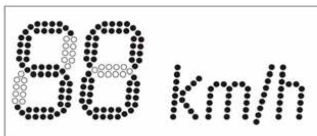
Segmento formado por vários Leds
