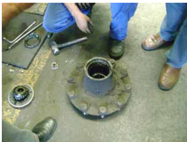
Figura 12 - Verificação do cubo
