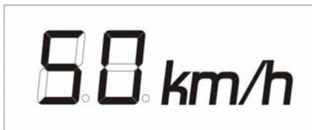
Segmento formado por um único LED
