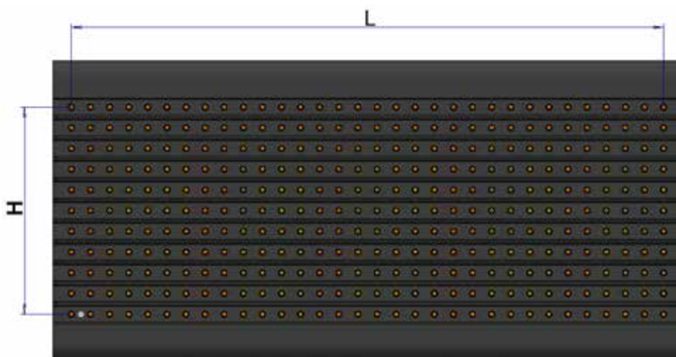
Figura 18 – Definição da área visível no painel eletrônico de Leds
