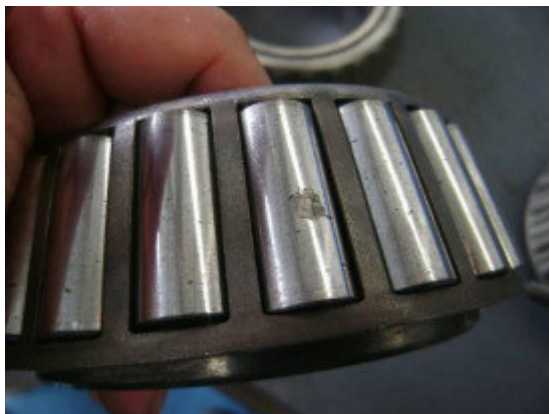
Figura 11 - Verificação do rolamento
