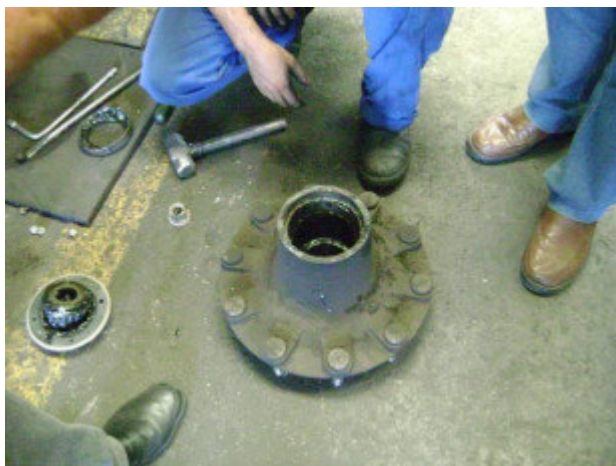
Figura 12 - Verificação do cubo
