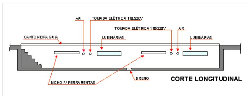
Figura 1 – Croqui da valeta de manutenção
