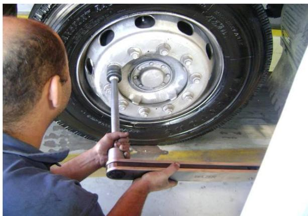
Figura 1 - Verificação do torque das porcas
