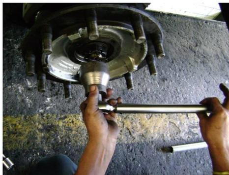
Figura 13 - Montagem do cubo com os rolamentos
