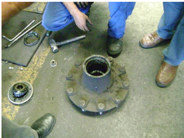
Figura 12 - Verificação do cubo
