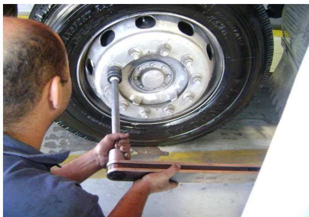
Figura 1 - Verificação do torque das porcas
