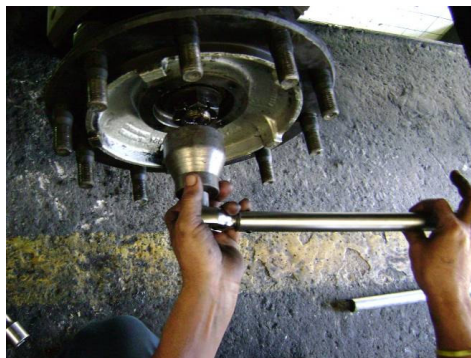
Figura 13 - Montagem do cubo com os rolamentos
