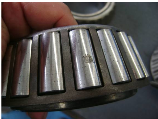
Figura 11 - Verificação do rolamento
