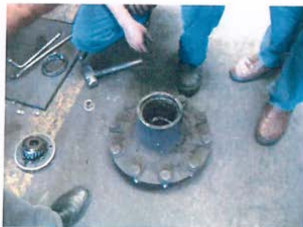
Figura 12 - Verificação do cubo
