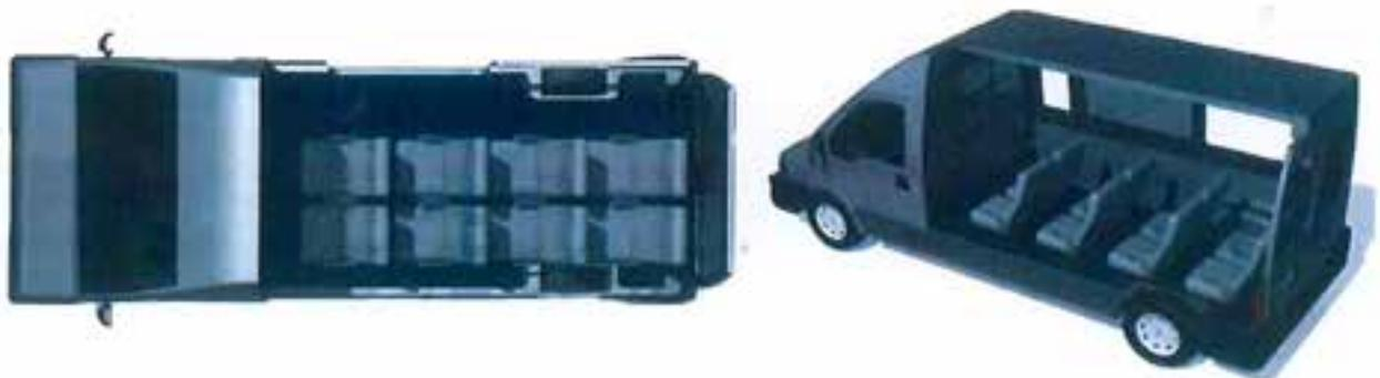
A distância entre a lateral esquerda do salão do veículo e os bancos dos passageiros deve ser de 150 a 250 mm, tendo como referência a face do assento e a lateral do veículo, conforme demonstrado na figura 3.
