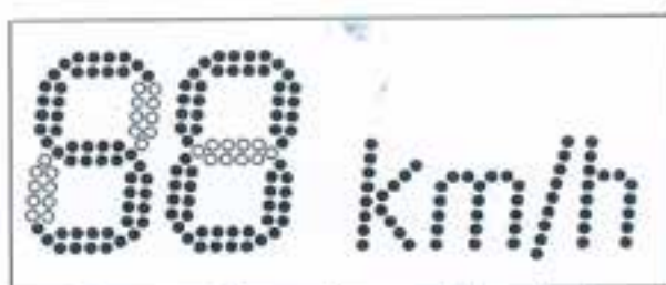
Segmento formado por vários Leds
