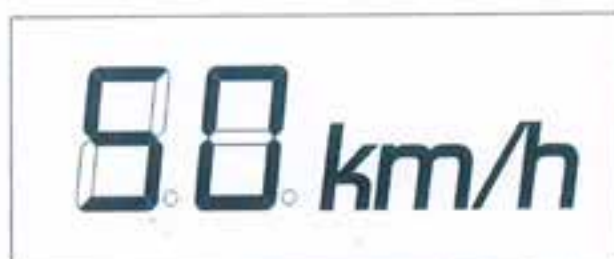
Segmento formado por um único Led
