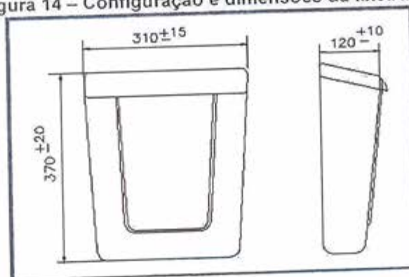
Figura 14 – Configuração e dimensões da lixeira
