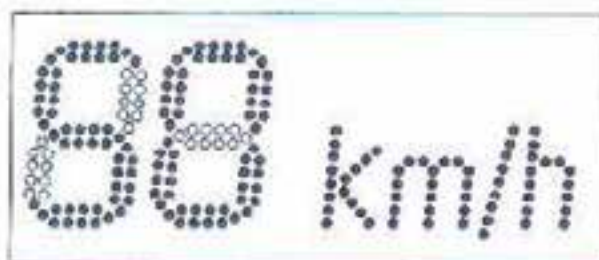
Segmento formado por vários LEDs
