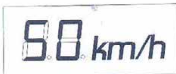
Segmento formado por um único LED
