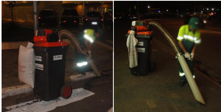
Foto: lutocar com sistema de aspiração de resíduos de varrição
