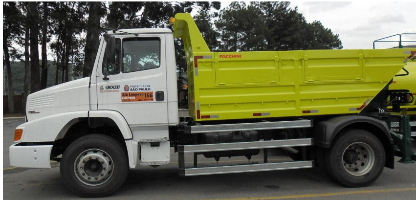
Foto: veículo basculante compacto para apoio à coleta e transbordo de resíduos
