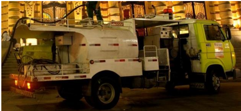
Foto: veículo para limpeza com água quente de monumentos, túneis, escadarias, passarelas, calçadões etc.
