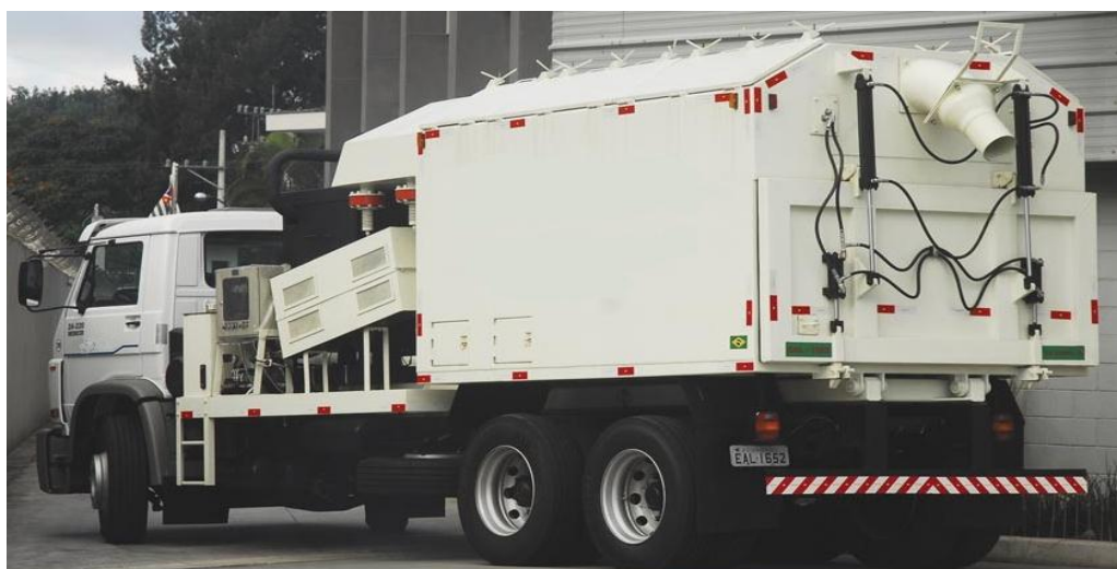
Foto: veículo de alta sucção de detritos para desobstrução e limpeza de bueiros e bocas de lobo
