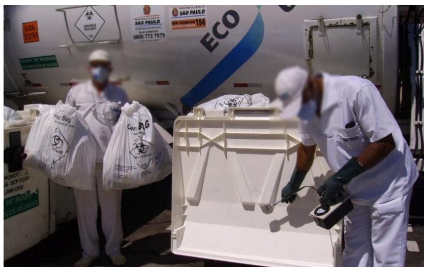
Foto: uso de contador geigema coleta de RSSS
