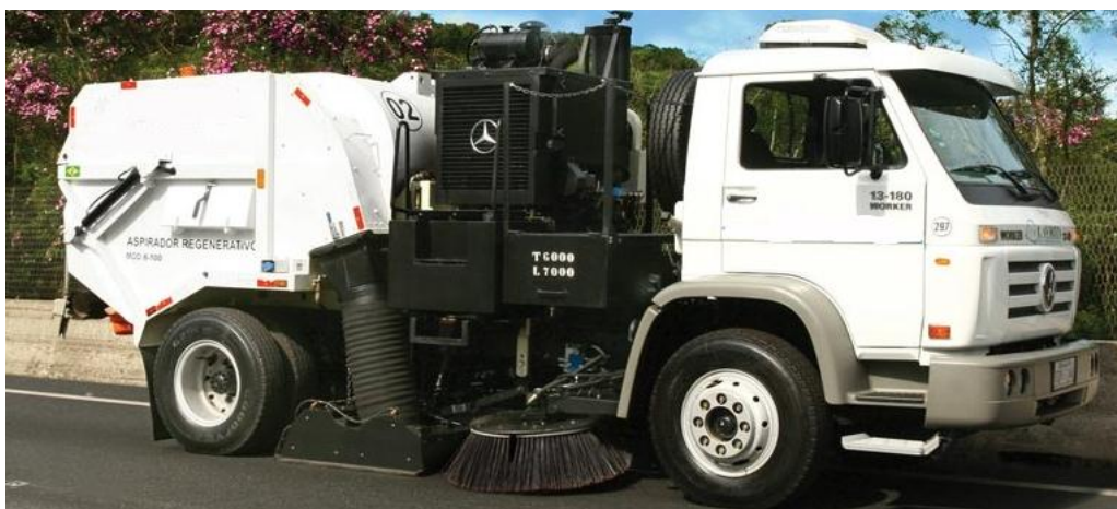
Foto: veículo aspirador de detritos em guias e sarjetas com auxílio de escovas e injeção de ar
