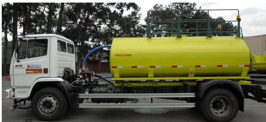
Foto: veículo pipa para lavagem pós-feiras livres, vias e logradouros em geral
