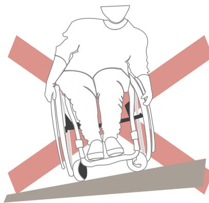
1c) ter inclinação transversal constante e não superior a 3% (três por cento);
